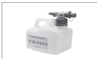
Jerry Can:液だれ防止安全注ぎ口付き燃料缶(CARB(カリフォルニア大気資源局)規制対応) 燃料缶(容量4.75 L)には、こだわりの安全機能が搭載されています。自動注入停止、スピード注入、親指操作の注入停止ボタン、自動通気装置を備え、バーナーの燃料となるe-NRGバイオエタノールを安全に保管・注入できます。
