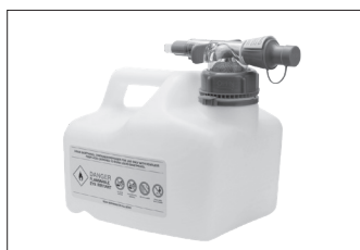
Jerry Can: 液だれ防止安全注ぎ口付き燃料缶 (CARB (カリフォルニア大気資源局) 規制対応) 燃料缶 (容量4.75 L) には、こだわりの安全機能が搭載されています。自動注入停止、スピード注入、親指操作の注入停止ボタン、自動通気装置を備え、バーナーの燃料となるe-NRGバイオエタノールを安全に保管・注入できます。
